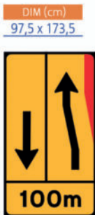
TD 22 - Painel de estreitamento à direita (1x2)
