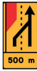
TD 20 - Painel de estrangulamento à esquerda (1x4) - Desvio da via esquerda para a via direita
