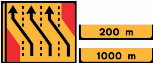
TD15 - Desvio de direcção (4 vias) Desvio das vias direita, central direita e central esquerda para as vias central direita, central esquerda e esquerda
