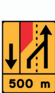
TD18 - Painel de estrangulamento à esquerda (1x2+VL) Desvio da via adjacente para a via de lentos
