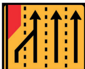
TD 6 - Painel de estrangulamento à esquerda (4 vias) - Desvio da via esquerda para a via central esquerda
