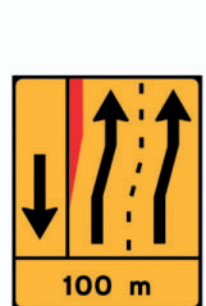
TD 27 - Painel de estreitamento à esquerda (1x2+VL)
