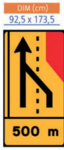
TD19 - Painel de estrangulamento à direita (1x4) - Desvio da via direita para a via esquerda
