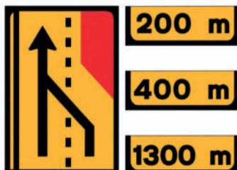
TD1/ST2 - Painel de estrangulamento à direita (2 vias) - Desvio da via direita para a via esquerda
