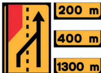
TD2 - Painel de estrangulamento à esquerda (2 vias) - Desvio da via esquerda para a via direita
