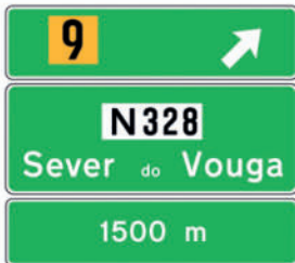
11-Pré-aviso simplificado (Intersecção desnivelada)
