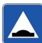
H48 - Lomba redutora de velocidade
