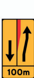
TD 23/ST6 - Painel de estreitamento à esquerda(1x2)
