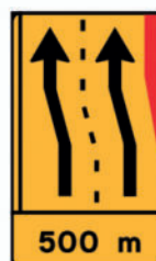
TD 30 - Painel de estreitamento à direita (1x4)
