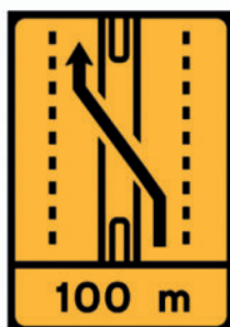
TD 9 - Desvio de faixa (2 x 2 vias) - Desvio da via esquerda para a via esquerda da faixa contrária
